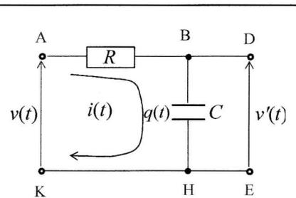
図1 RC 四端子回路
